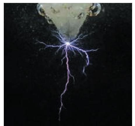
図1 水中放電の様子(ストリーマの発光)
